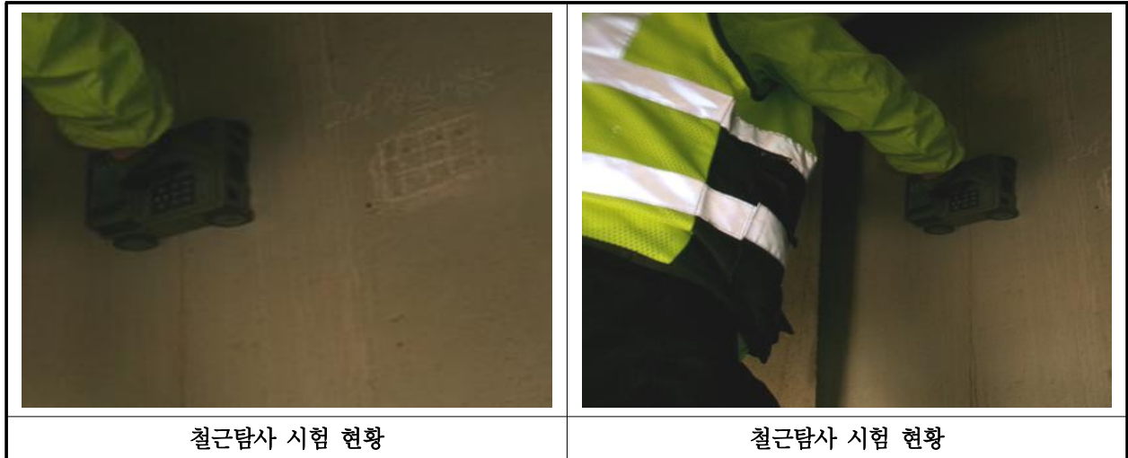
【사진 2.4.2】 철근탐사 시험
